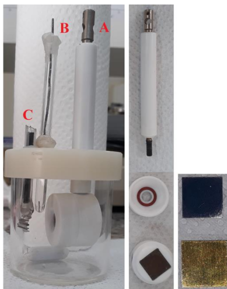
Figura 5: Célula eletroquímica utilizada para as medidas voltamétricas, com eletrodo de trabalho (A), eletrodo referência (B) e contra-eletródo (C). Ao lado, o eletrodo de trabalho desmontado, apresentando a forma de contato elétrico e a alocação do DDB (1 cm 2 ).
