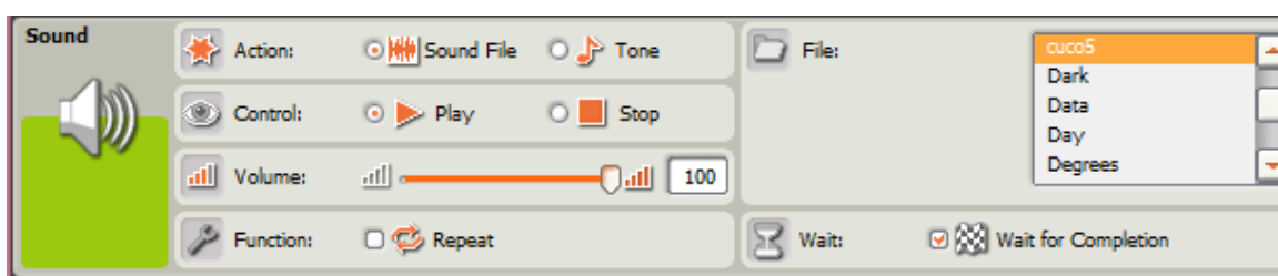
Figura – 29: Configuração do Bloco de áudio para o cuco no segundo loop
