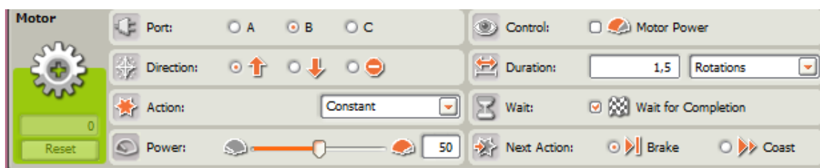
Figura – 29 Configuração do Bloco do Motor B no segundo loop
