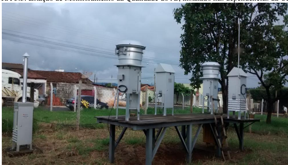
FIGURA 3.3: Estação de Monitoramento da Qualidade do Ar, instalado nas dependências da UFG-RC.
