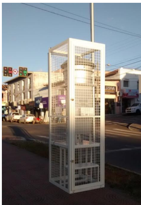
FIGURA 3.5: Estação de Monitoramento da Qualidade do Ar, instalado no Centro da cidade de Catalão – GO.
