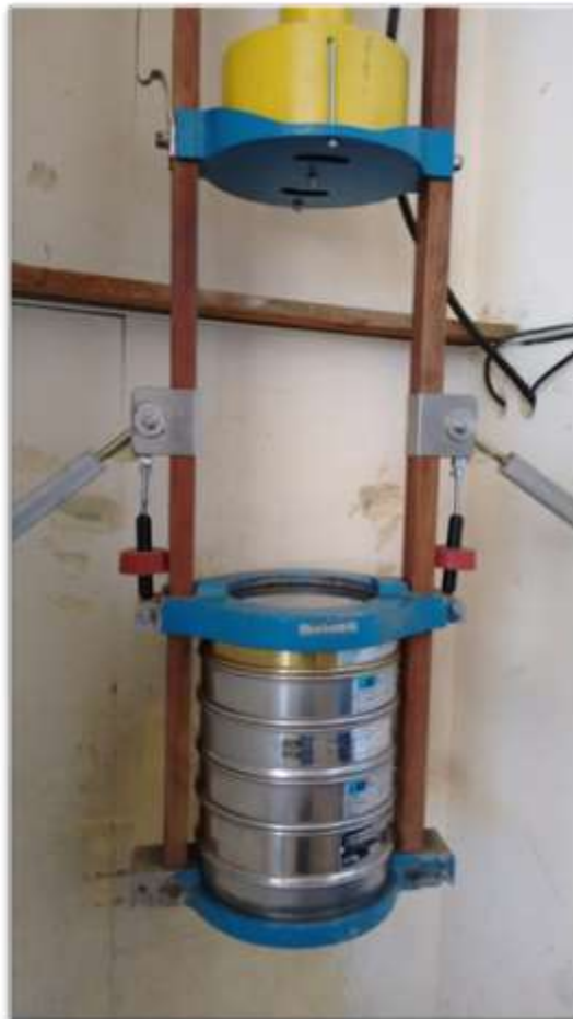
Figura 12: Agitador de peneiras suspenso utilizado para separação granulométrica.
