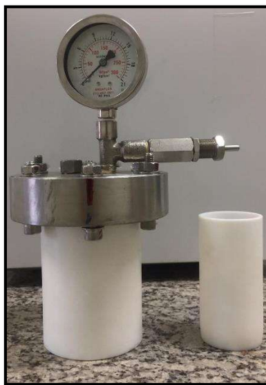
Figura 2. 5. Reator e copo coletor de teflon do sistema HAMO.
