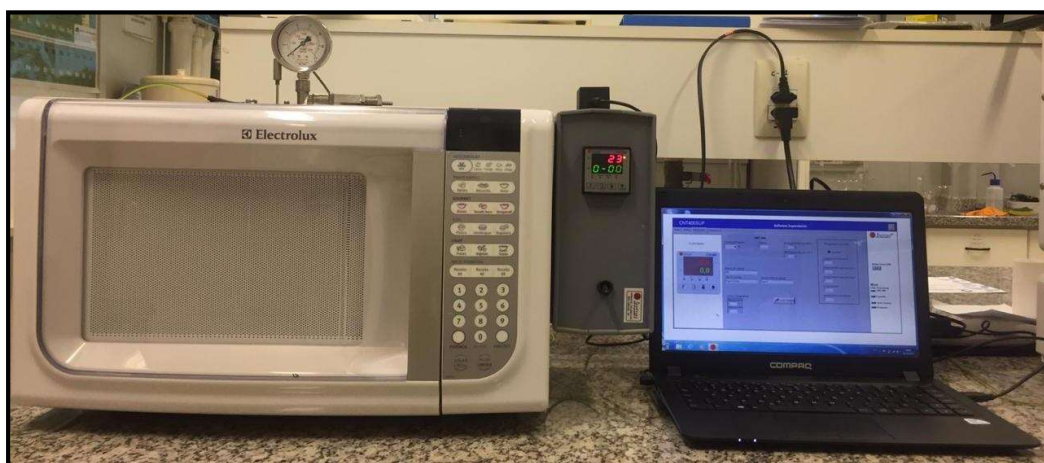
Figura 2. 4. Sistema hidrotérmico assistido por micro-ondas.
