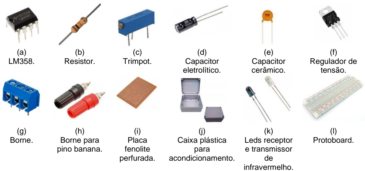
Figura 5.6 – Ilustração dos componentes eletrônicos utilizados na montagem do sensor de pulsos. Fonte: o próprio autor (2019)
