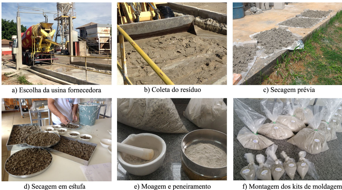
Figura 3.3 – Processo de obtenção da LRC (a, b) e preparação da LRC-S para utilização (c-f).
