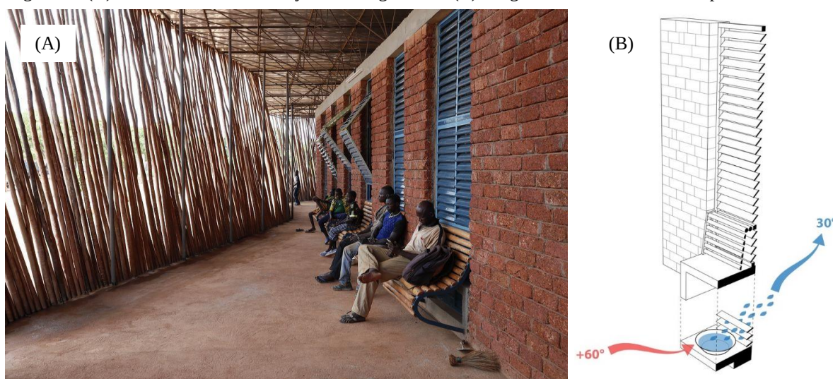
Figura 2 - (A) Escola Secundária de Lycee Schorge, 2016. (B) Diagrama de resfriamento evaporativo.
