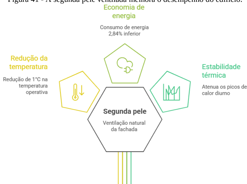
Figura 41 - A segunda pele ventilada melhora o desempenho do edifício.
