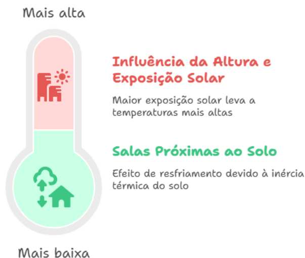
Figura 43 - Influência da altura e da exposição solar na temperatura interna.
