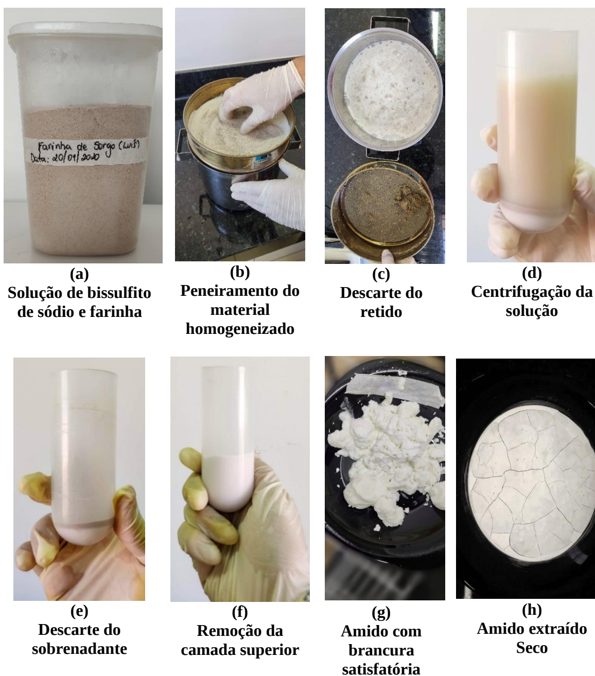
Figura 5.4 – Processos envolvidos na etapa de geração dos amidos oriundo das farinhas de sorgo e milheto
