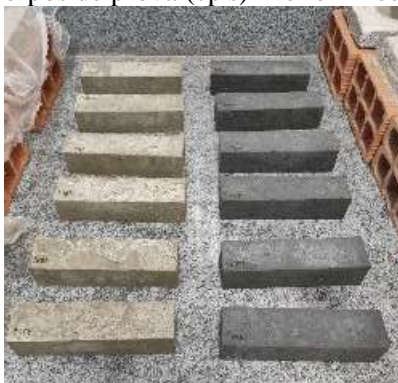
Figura 3. 11 - Corpos de prova (cp's) Tref e Tméd, dosados em t0.
