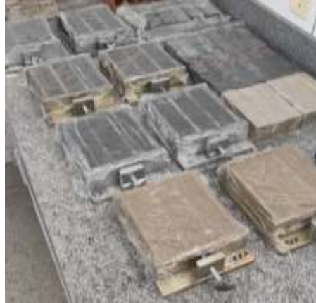
Figura 3. 6 - Cura seca dos cp's de argamassa.
