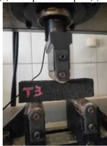
Figura 3. 7 – Ensaio de tração na flexão e compressão simples: prensa universal (a), tração na flexão (b) e compressão simples (c).
