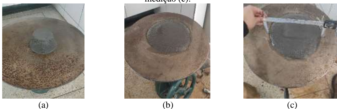
Figura 4. 9 - Ensaio de consistência pelo espalhamento na mesa: antes do ensaio (a), após ensaio (b) e medição (c).
