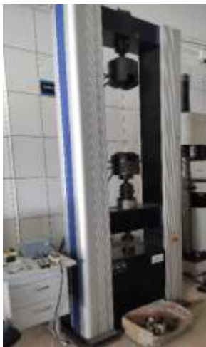
Figura 3. 7 – Ensaio de tração na flexão e compressão simples: prensa universal (a), tração na flexão (b) e compressão simples (c).
