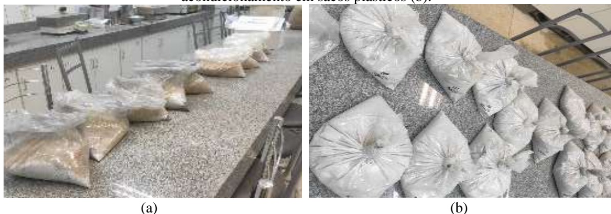
Figura 3. 9 - Traço ideal da argamassa modificada com cinzas de biomassa: pré-dosagem (a) e acondicionamento em sacos plásticos (b).
