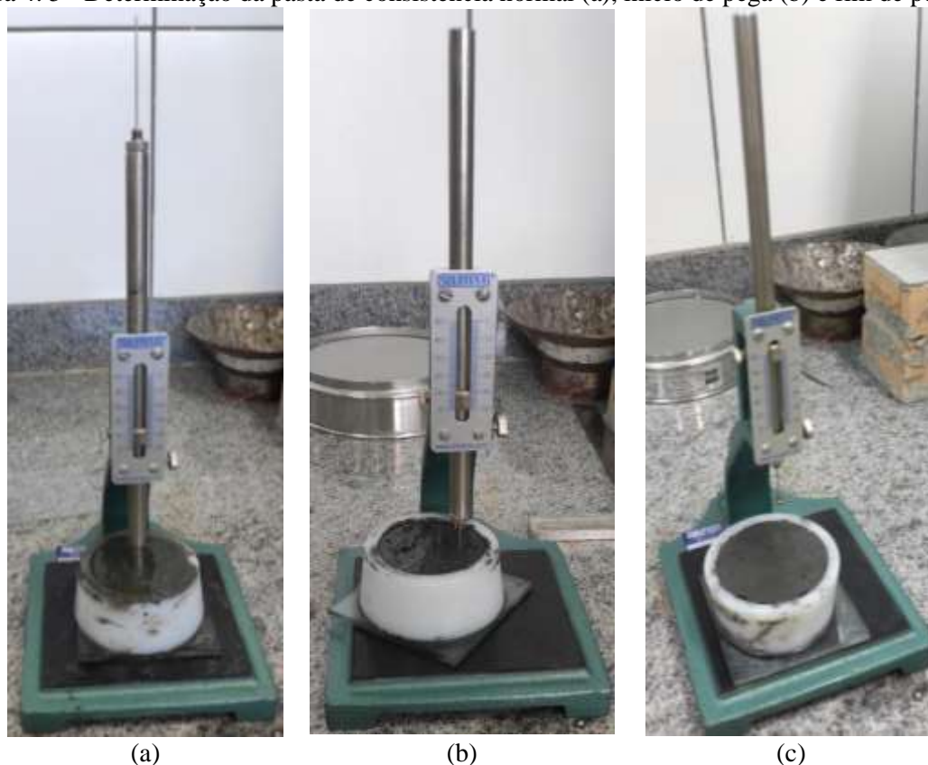
Figura 4.5 - Determinação da pasta de consistência normal (a), início de pega (b) e fim de pega (c).
