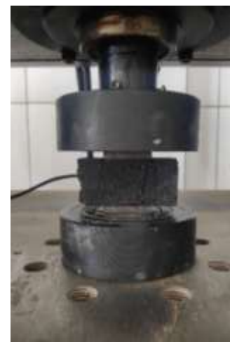
Figura 3. 7 – Ensaio de tração na flexão e compressão simples: prensa universal (a), tração na flexão (b) e compressão simples (c).
